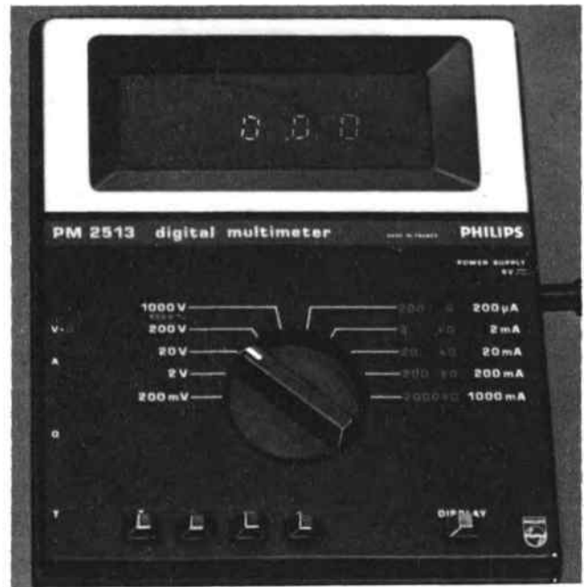
Bild 4.3: Hochohmiges analog anzeigendes Meßinstrument (links) und hochohmig digital anzeigendes Meßinstrument (rechts).
